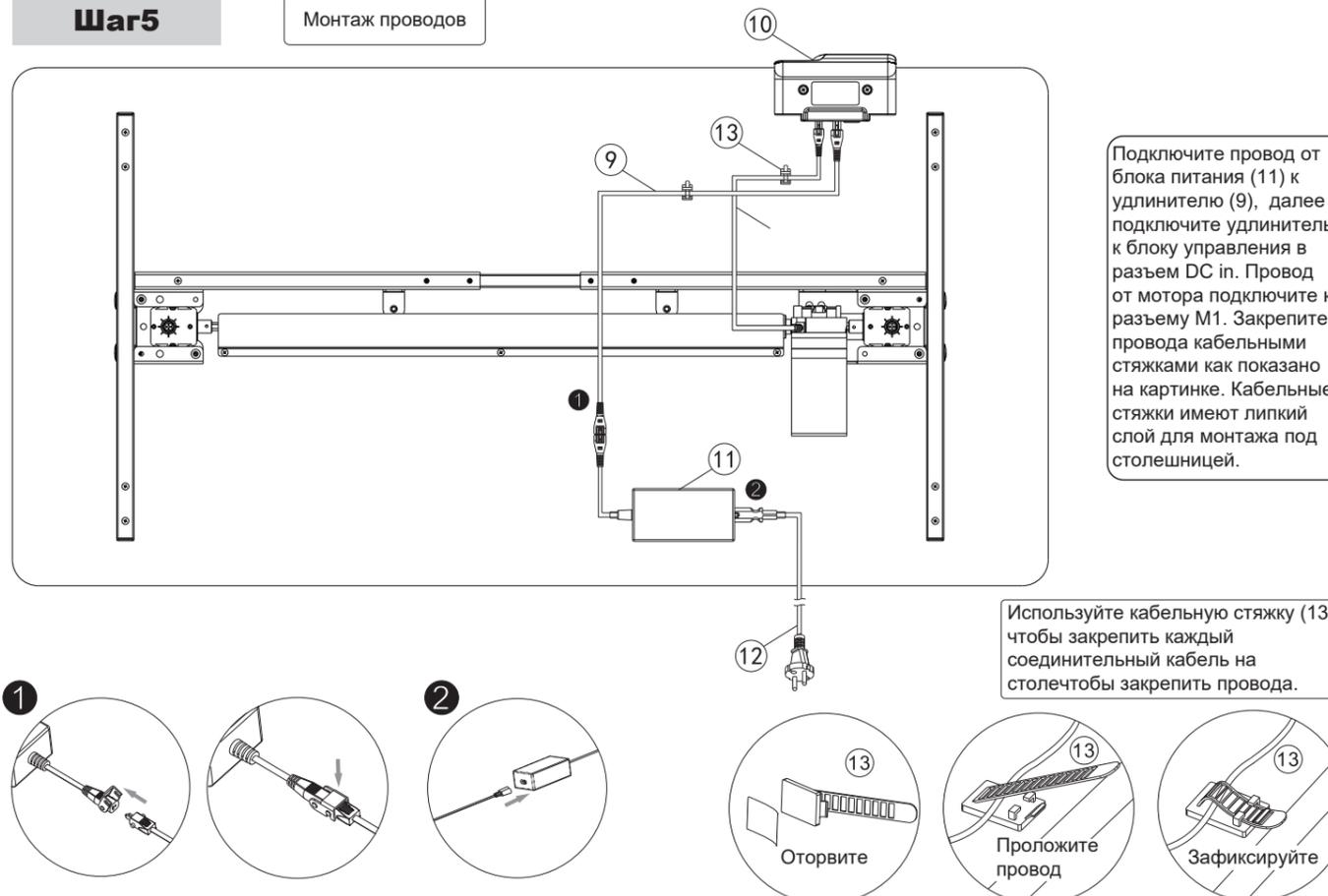
Подключите провод от блока питания (11) к удлинителю (9), далее подключите удлинитель к блоку управления в разъем DC in. Провод от мотора подключите к разъему M1. Закрепите провода кабельными стяжками как показано на картинке. Кабельные стяжки имеют липкий слой для монтажа под столешницей.
