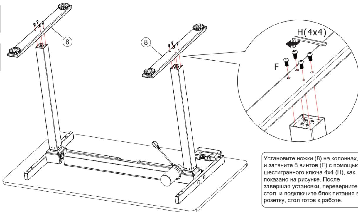
Установите ножки (8) на колоннах, и затяните 8 винтов (F) с помощью шестигранного ключа 4x4 (H), как показано на рисунке. После завершения установки, переверните стол и подключите блок питания в розетку, стол готов к работе.
