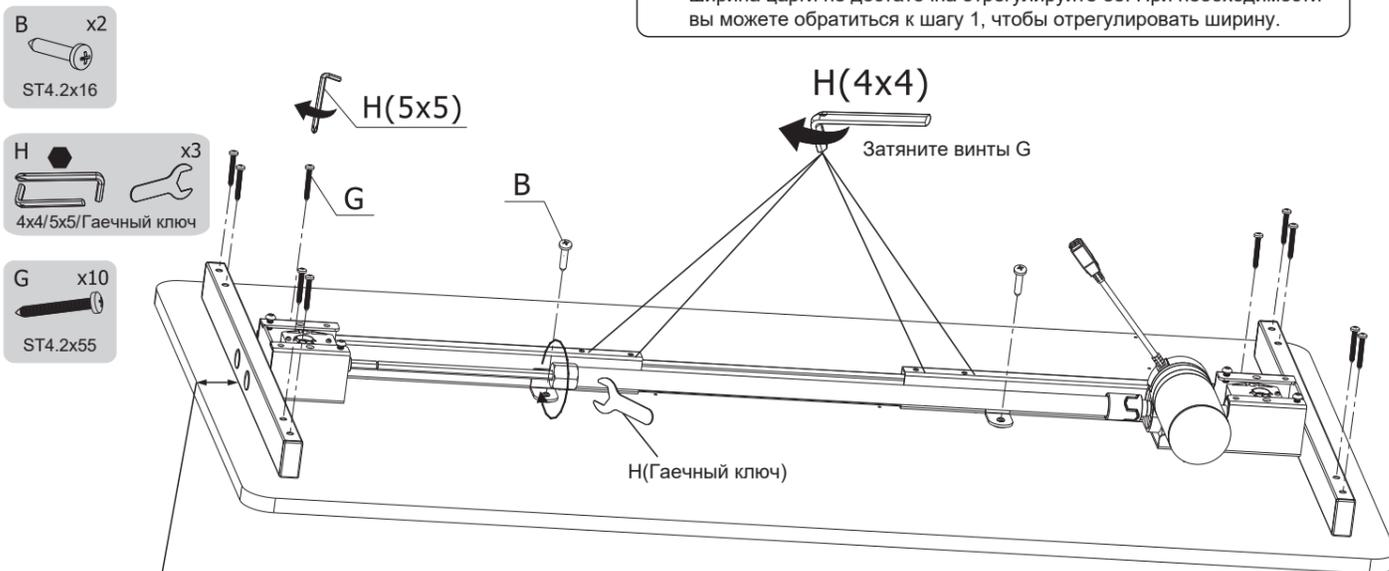
**!** Примечание: поместите царгу на середину столешницы, выставьте равное расстояние с каждой стороны, затем зафиксируйте ее. Если ширина царги не достаточна отрегулируйте ее. При необходимости вы можете обратиться к шагу 1, чтобы отрегулировать ширину.
