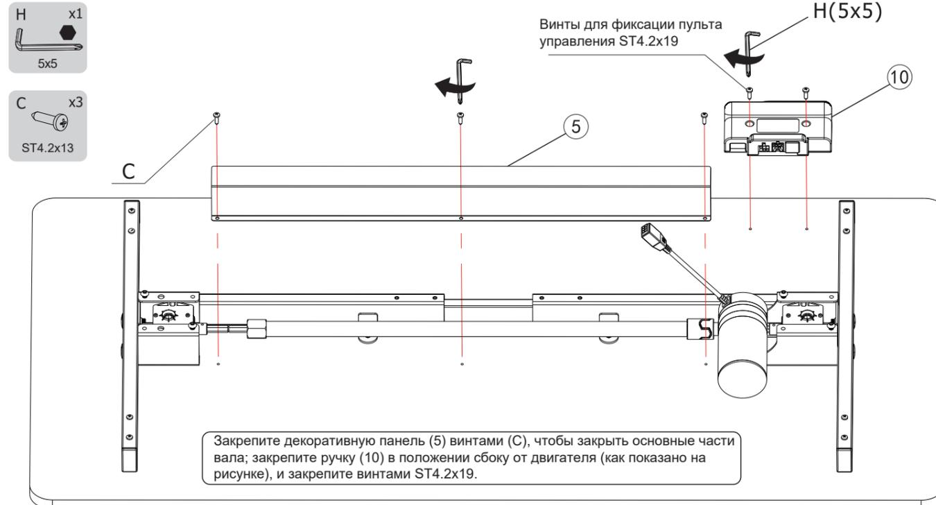
Закрепите декоративную панель (5) винтами (C), чтобы закрыть основные части вала; закрепите ручку (10) в положении сбоку от двигателя (как показано на рисунке), и закрепите винтами ST4.2x19.
